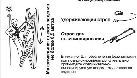
Рис. 12б. Оборудование для удержания или позиционирования
