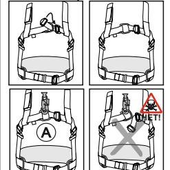
Рис. 6. Типы используемых пряжек, способы заправки пряжки Фаст (для VST 043)
