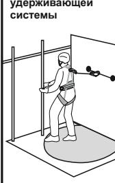
Рис. 12а. Позиционирование в рабочем положении
